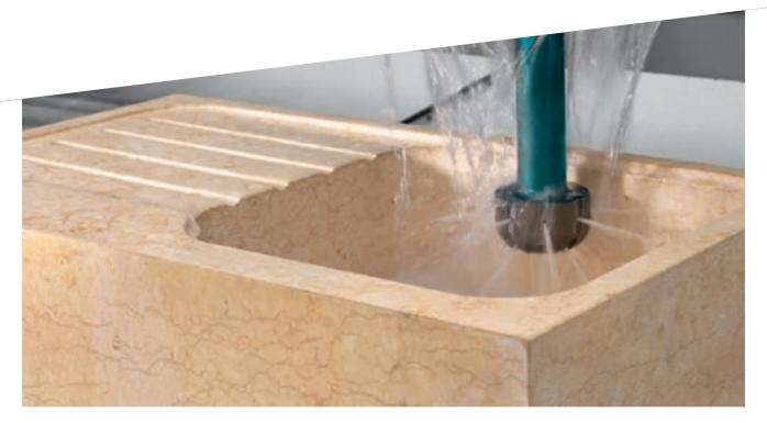
THE MACHINE CAN BE EQUIPPED WITH A 15 KW SPINDLE FOR MAXIMUM PRODUCTIVITY EVEN IN HEAVY-DUTY MACHINING OPERATIONS.
